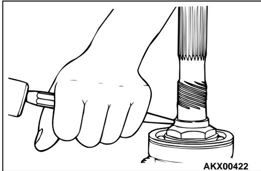
**>>D<< JAM NUT INSTALLATION**
