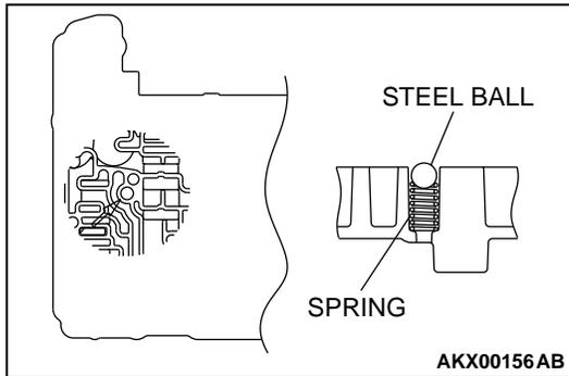
**>>F<< SPRING/STEEL BALL (ORIFICE CHECK BALL)/
