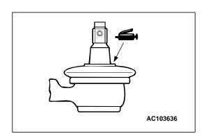
>>A<< RELAY ROD AND BALL JOINT CONNECTION
