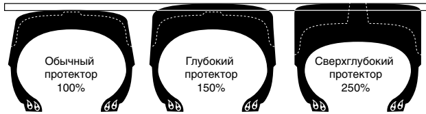
Сравнение обычного, глубокого и сверхглубокого протектора
