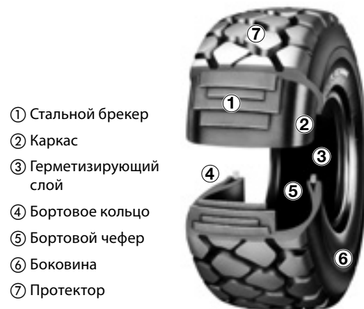
Схематичное изображение КГШ Радиальной конструкции
