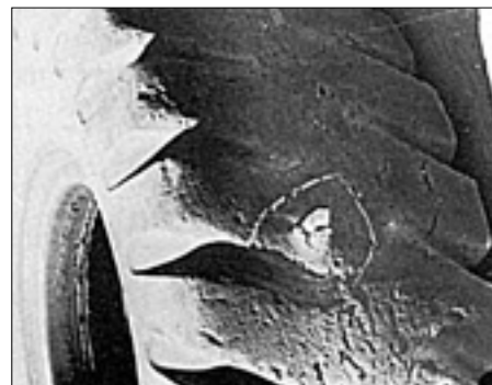
Порезы протектора (проникающие)
