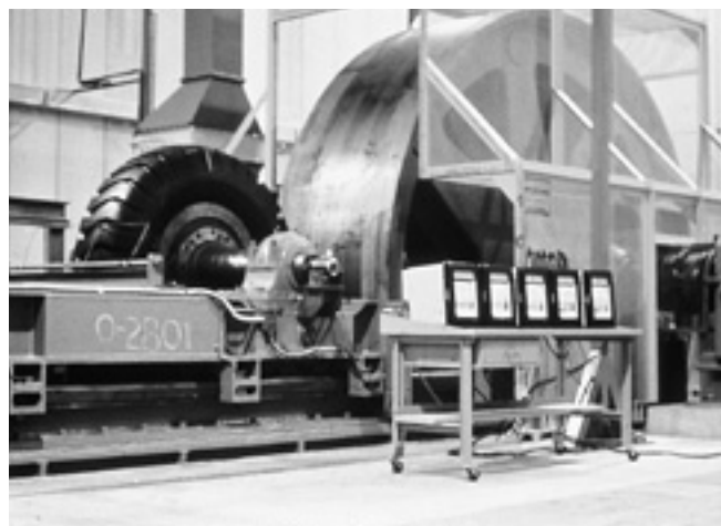
Барабанный стенд для испытаний шин
