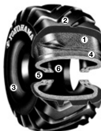
Схематичное изображение КГШ диагональной конструкции
