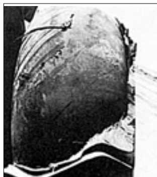
Отслоение протектора
