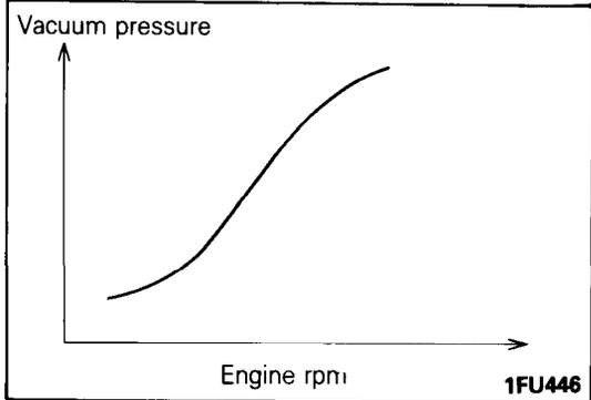
**INSPECTION OF EGR VALVE CONTROL VACUUM (E VACUUM)**
