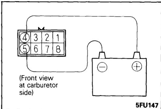
**SIMPLE INSPECTION OF FEEDBACK SOLENOID VALVE (FBSV)**
