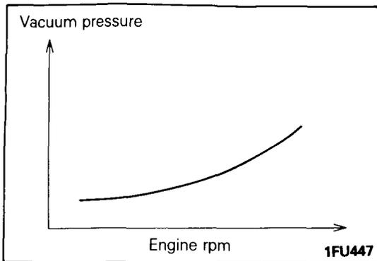
**INSPECTION OF VACUUM SWITCH CONTROL VACUUM (F VACUUM)**
