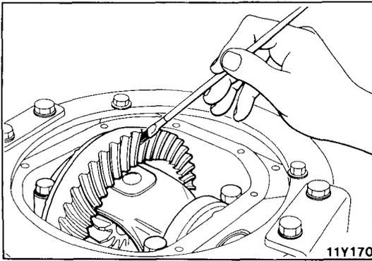
**FINAL DRIVE GEAR TOOTH CONTACT**
