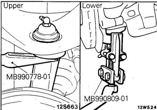
**6. DISCONNECTION OF LOWER BALL JOINT FROM KNUCKLE/8. UPPER BALL JOINT FROM KNUCKLE**
