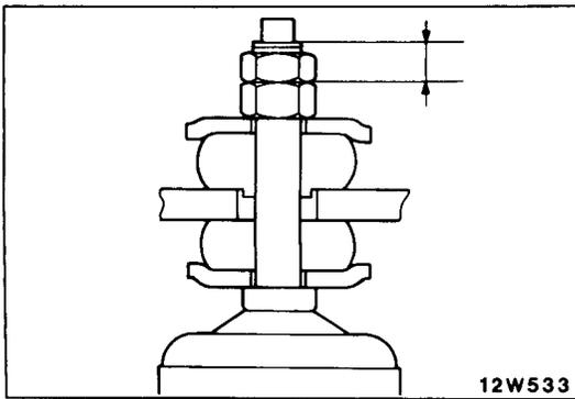
**1. INSTALLATION OF SHOCK ABSORBER**
