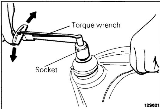
**UPPER BALL JOINT STARTING TORQUE**
