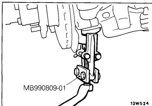
**5. DISCONNECTION OF LOWER BALL JOINT FROM KNUCKLE**
