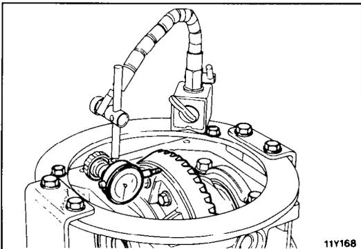
**DRIVE GEAR RUNOUT**
