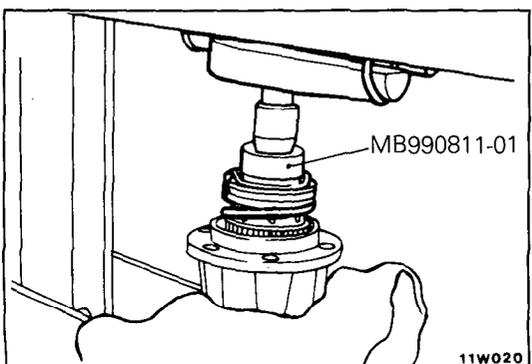
**10. REMOVAL OF DRIVE GEAR ASSEMBLY/11. SLIDE GEAR ASSEMBLY/12. RETURN SPRING**
