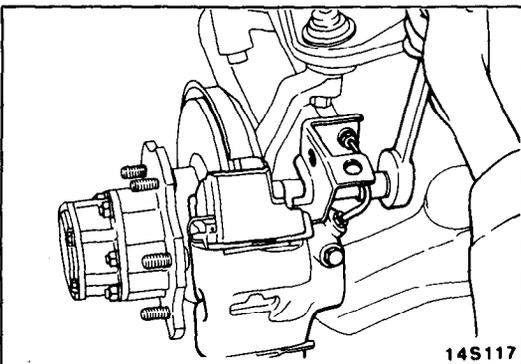
**5. REMOVAL OF FRONT BRAKE ASSEMBLY**
