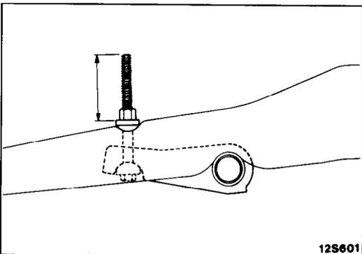
**● ADJUSTMENT OF CLEARANCE BETWEEN BUMP STOPPER AND BUMP STOPPER BRACKET**
