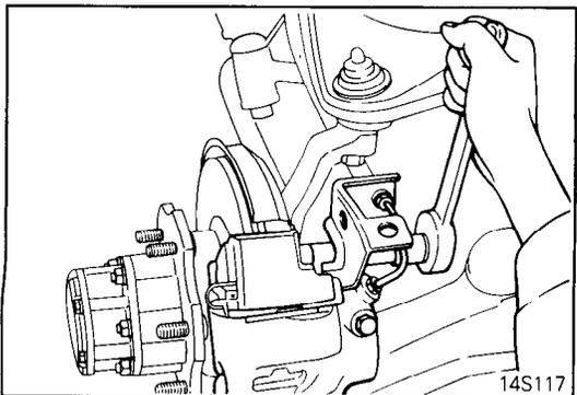
**7. REMOVAL OF FRONT BRAKE ASSEMBLY**
