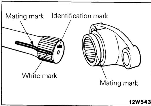
**5. INSTALLATION OF TORSION BAR**
