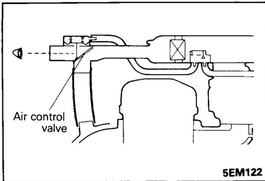
**INSPECTION OF INTAKE AIR TEMPERATURE CONTROL SYSTEM**
